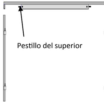
3. Se colocan los abisagrados y se introduce la pestaña del superior en los mismos (el pestillo del superior siempre debe quedar hacia fuera).
