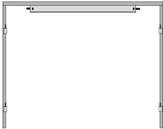
4. Se presenta el marco ya montado en el hueco de puerta. Debe montarse lo mas próximo al borde exterior del hueco de la puerta para que las dos hojas abatan bien.
