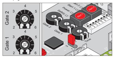
Con los potenciómetros «Gate 1 (M1)» y «Gate 2 (M2)» se ajusta la longitud de las hojas de la puerta en el controlador. La velocidad de marcha y la tolerancia de fuerza para la hoja correspondiente de la instalación de puerta se determinan según este ajuste.
