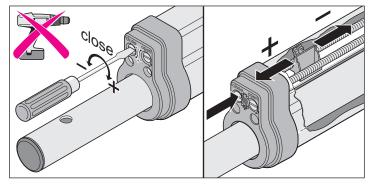
Si fuera necesario, reajuste la posición final con un destornillador.
