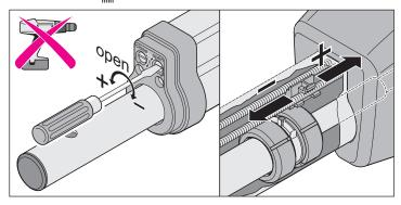
Si fuera necesario, reajuste la posición final con un destornillador.
