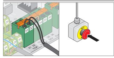
Retire los puentes de alambre antes de realizar la conexión.
