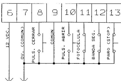
**6 - 7 SALIDA 12 VDC.** Para alimentar accesorios: fotocélula, receptor, etc... que se alimentan con 12 V. de tensión continua.
